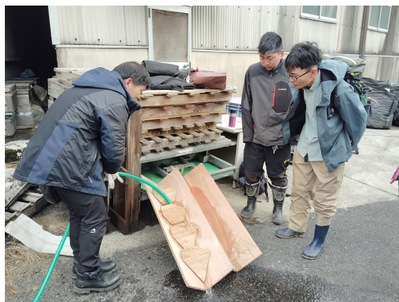
(写真8) 可搬魚道（ポータブル魚道）のデモンストレーションの様子
